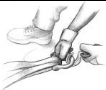
Fase 18: STACCARE LA FUNE METALLICA. Staccare dall'ancoraggio.
